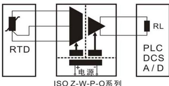
PT100热电阻信号隔离变送器典型应用(有源型)
